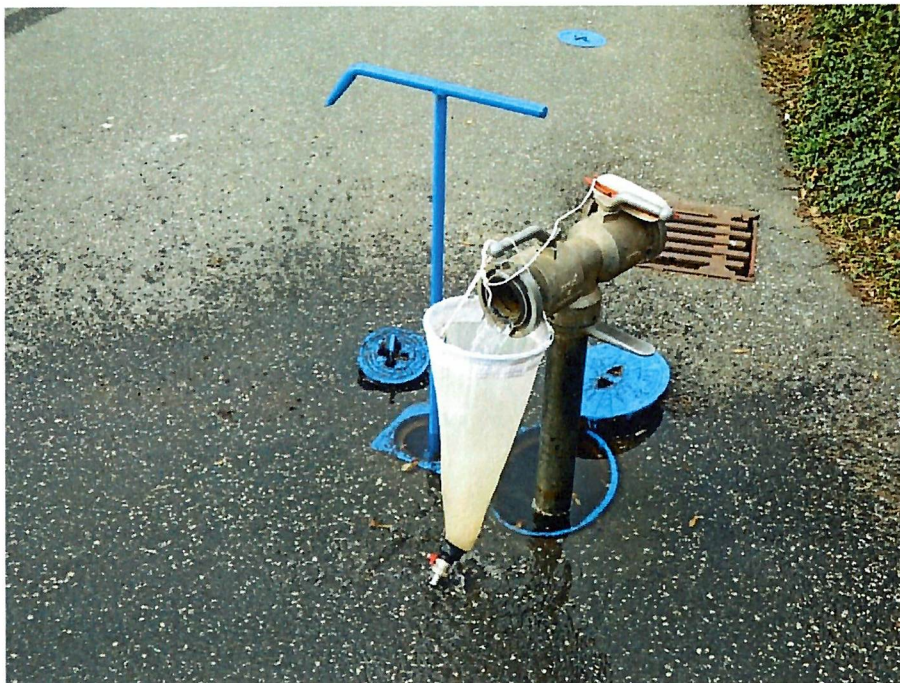
Obr. 1. Odběr velkoobjemového vzorku na síti přes planktonní sítku, Straník 13. 11. 2025.
